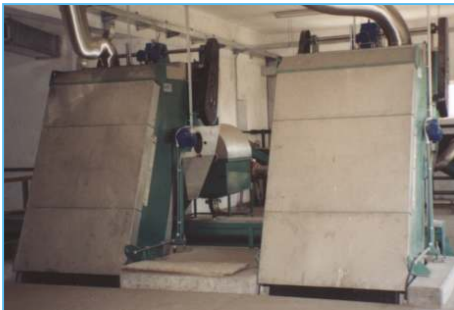
Dvojice česlí s krytem napojeným na centrální odsávání
